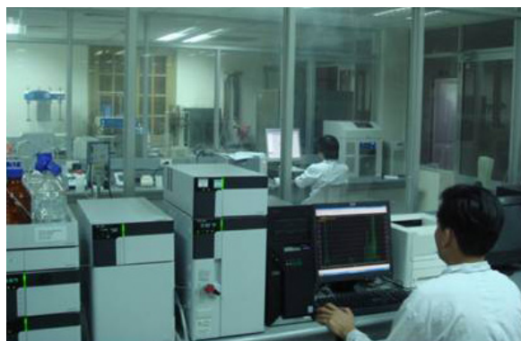
Kiểm nghiệm dư lượng thuốc kháng sinh trong thực phẩm bằng máy sắc ký lỏng hiệu năng cao (HPLC)
